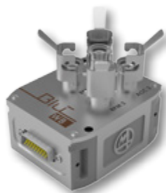
Nodo WB a 2 sensori di vibrazione + 2 sensori rpm
